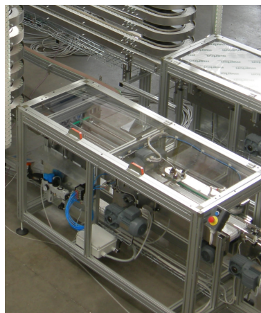
BAT-BUFFER doppio per scatole di caramelle. Capacità 200 p/min ciascuno.
